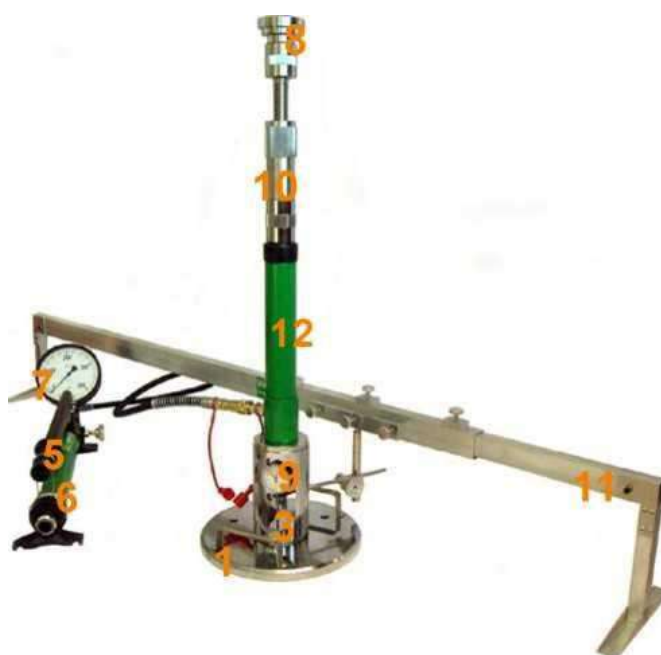
Rys. 1.2 Aparatura VSS z jednopunktowym pomiarem przemieszczenia płyty
