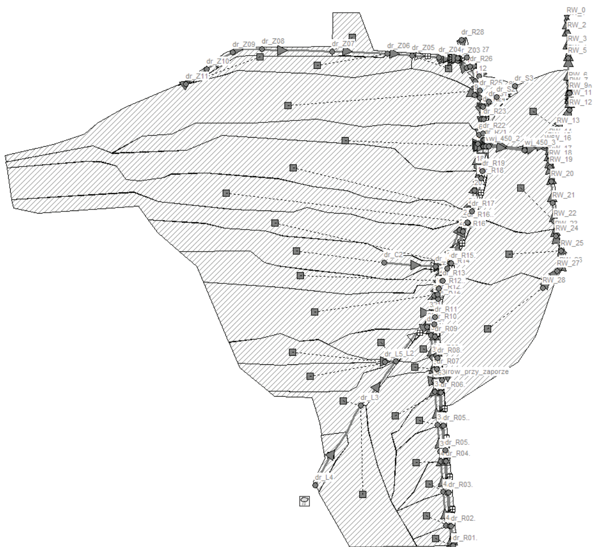
Rys.1. Model hydrodynamiczny kanalizacji deszczowej wykonany w SWMM – zlewnia kanalizacji
