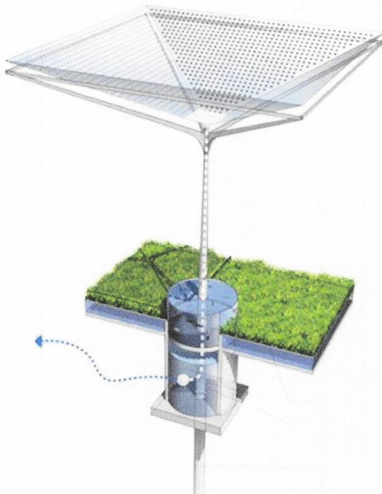
Insp. 2 Przykładowe rozwiązanie do „łapania” wody deszczowej w formie odwróconego parasola https://pl.pinterest.com/
