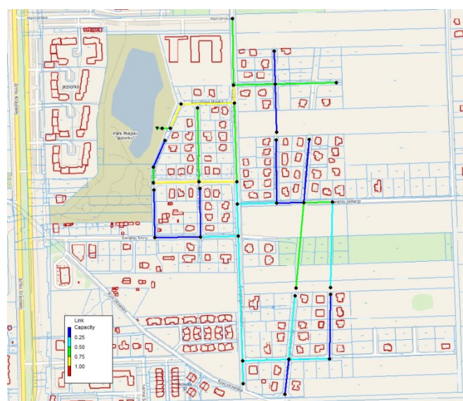
Rys 13. Graf kolektorów po wprowadzonym limicie odpływu oraz dostosowaniu średnic do retencji kanałowej
