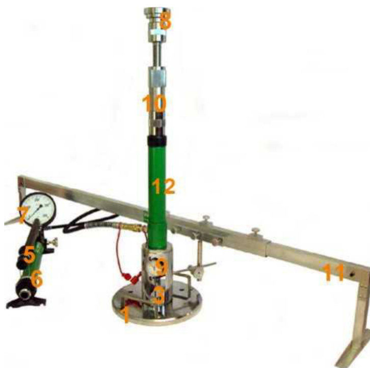
Rys. 1.2 Aparatura VSS z jednopunktowym pomiarem przemieszczenia płyty
