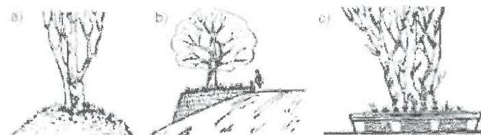
a) pozostawiony ścięty stożek z gruntu, ochraniający korzenie drzewa b) ścianka podporowa z kamienia wokół drzewa pozostawionego na skarpie c) ścianka oporowa dostosowana do odpoczynku podróźnych przez wykonanie ławki na jej górnej powierzchni Rys. 3. Niecka o łagodnym pochyleniu, dostosowująca drzewo do otaczającego terenu podwyższonego o 0,2 ÷ 0,4 m (wg [10])
